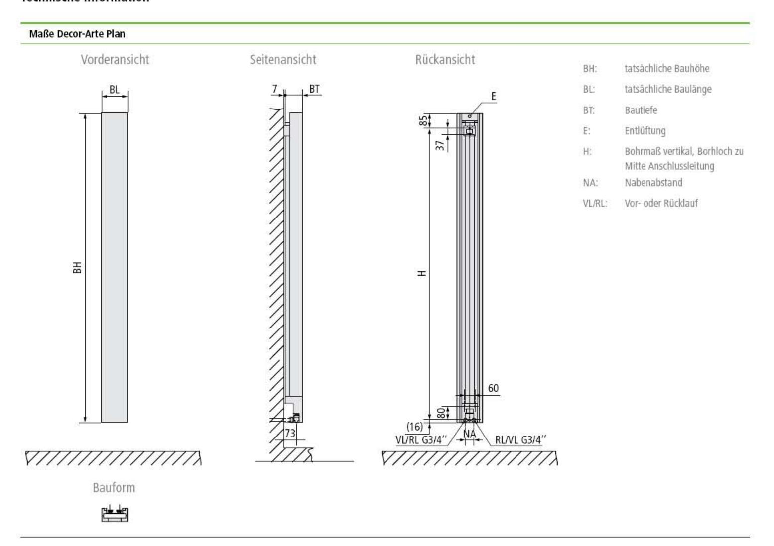
Abstand Unterkante Heizkörper zu Boden min. 150 mm.
