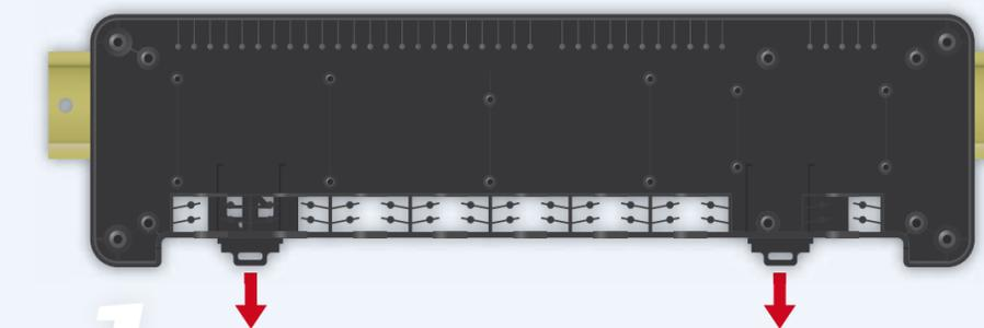
1 · Klipsen Sie die Basis auf die Service Schiene oder befestigen Sie diese mit Schrauben und Dübeln auf der Wand.
