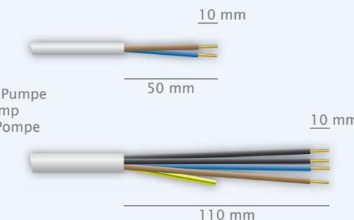
2 · Schneiden Sie die Kabel der Verbraucher, der Thermostate und des Anschlusses auf die oben angegebenen Längen.
