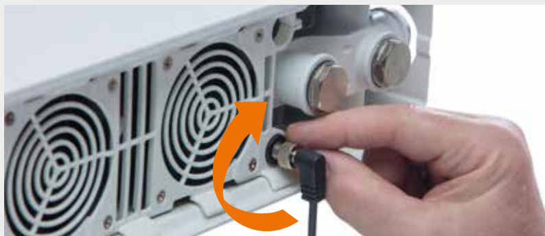
Abbildung 10: Hohlbuchsenstecker einstecken und verschrauben
