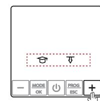
Deaktivieren/Aktivieren Sie den Bodensensor mit Hilfe der „+“ Taste.
