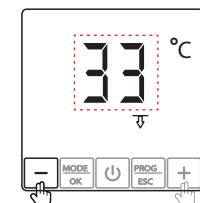
Stellen Sie die maximale Raumtemperatur mit Hilfe der „+“ oder „-“ Taste ein.
