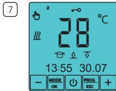
Bei Erstinbetriebnahme wechselt das Thermostat automatisch in den Modus „TEMPERATUR HALTEN“ und der dazugehörige Bildschirm wird angezeigt. Wenn das Thermostat bereits im Einsatz war und nur erneut eingeschaltet wird, wechselt die Anzeige zu dem Modus, der vor dem Ausschalten aktiv war.
