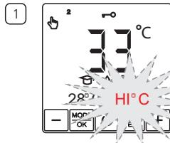
HI °C Anzeige für den Fall, dass eine Temperatur höher als +45°C erreicht wird.
