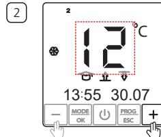
Die Frostschutztemperatur mit Hilfe der „+“ oder „-“ Taste einstellen.
