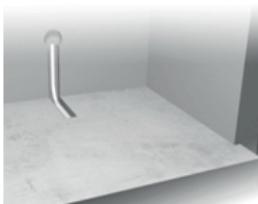
Der Boden, auf dem die Heizeinheit aufgebracht wird, muss eben, sicher, fest und ausreichend belastbar sein. Vor dem Verlegen der Heizmatte auf dem Estrich, muss der Untergrund sauber, trocken, fest, staub- und schmutzfrei sein. Sollte der Unterbau uneben sein, so ist dieser vor der Verlegung der Heizelemente zu nivellieren, sodass Hohlräume unterhalb der Heizleitung vermieden werden. Bewegungsfugen in der Unterkonstruktion dürfen auf keinen Fall mit dem Flächenheizelement überbrückt werden.
