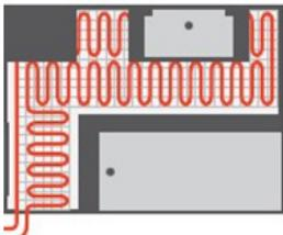
Fixieren Sie die Elektro-Comfort-Dünnbettbeheizung gemäß Ihrem Verlegeplan mit der Klebeseite auf dem Untergrund. Schneiden Sie an der vorgesehenen Wendestelle das Glasfasergewebe ein (**Achtung! Heizleitung nicht beschädigen!**) und verlegen Sie die Heizmatte, wie in der Illustration dargestellt.
